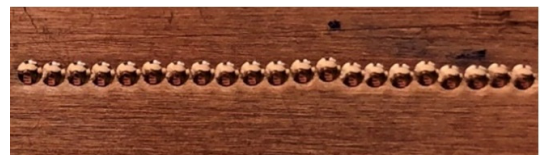
(d) Indentation test at 1 indent diameter spacing for 9.525-mm-thick copper (1 row)
