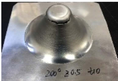
(d) D = 10 mm, S = 200 mm/min, Z = 0.5 mm, T = 200 °C
