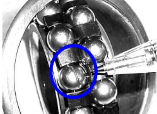
Fig. 32. Rolling element fault.
