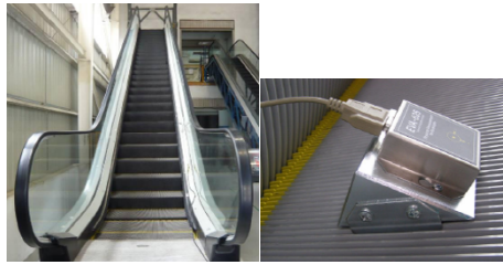
Fig. 5. PMT measurement of an actual escalator.
