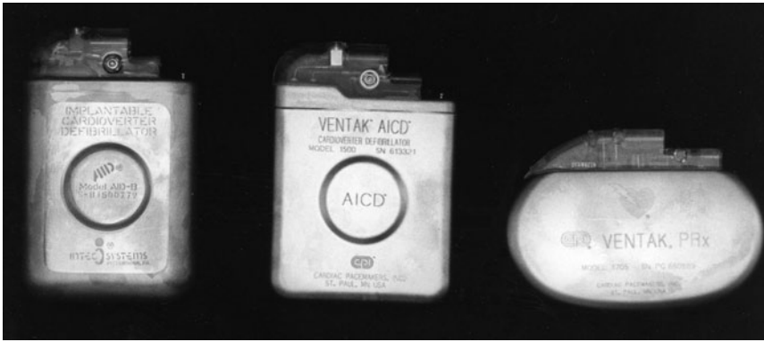
Abb. 1 ▲ Darstellung der ersten Generation von Kardioverter-Defibrillatoren, die beim Menschen implantiert wurden. Ganz links ist der erste implantierbare Kardioverter-Defibrillator (ICD) zu erkennen, der von der Firma Intec hergestellt wurde, die mit Mirowski seine Idee vom ICD-System realisierte
