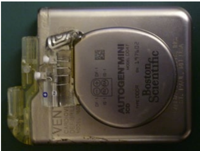
Abb. 5 ▲ Der neue Defibrillator vom Typ Autogen-Mini (Fa. Boston Scientific, USA) im Vergleich zu einem „frühen“ Defibrillator vom Typ Ventak P 1600 (Fa. CPI, USA). Der Defibrillator vom Typ Autogen-Mini „passt“ gut in den Ventak P 1600 hinein. (Mit Genehmigung)
