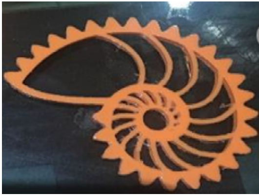
Fig. 17 Non circular gear
