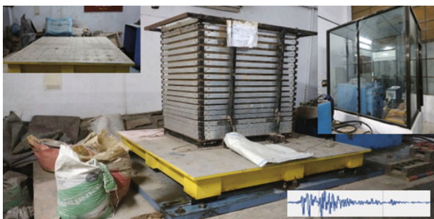
Fig. 3 Shaking table test apparatus
