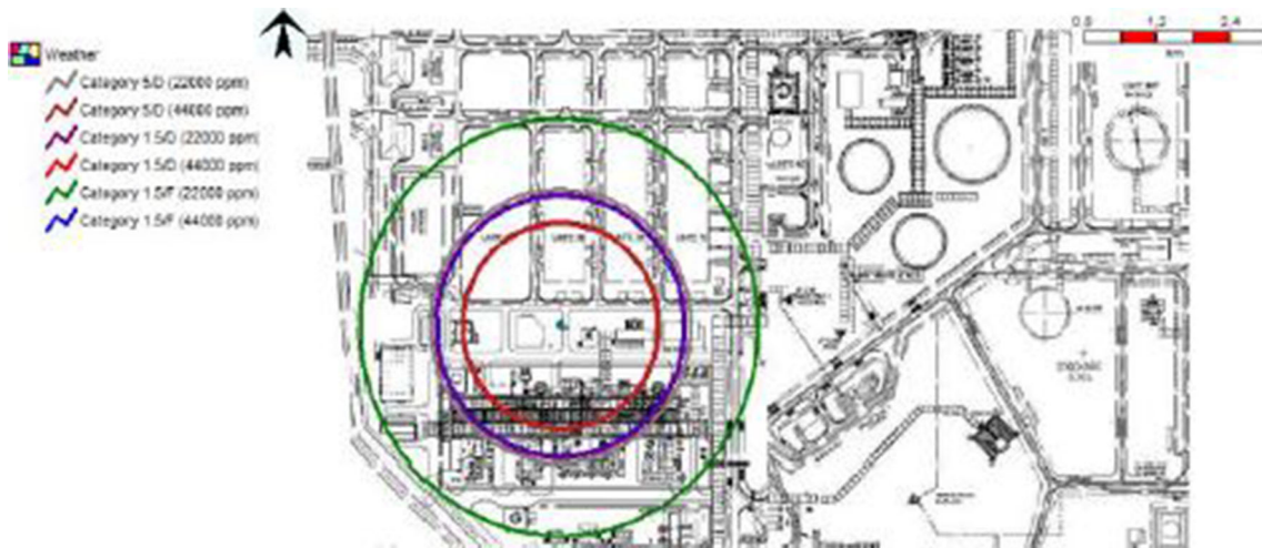
Fig. 8 Flash fire effects of on the LNG unit (surface plan)
