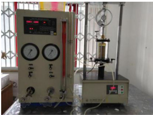
Fig. 10 Triaxial test apparatus
