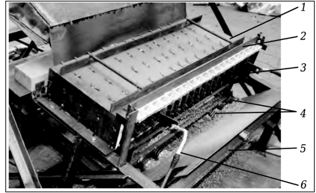
Fig. 1. Physical model: 1) heat cover; 2) panel; 3) mounting; 4) springs; 5) frame; 6) cable.
