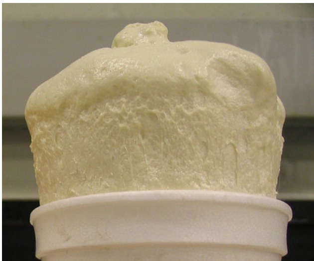
Fig. 3 Expanded PU foam from soy polyol
