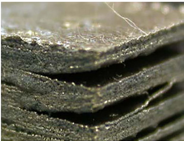
Fig. 11 Delamination (Zäh & Lutzmann, 2010)
