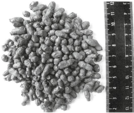
**Fig. 3.** Porous fill (keramzit).
