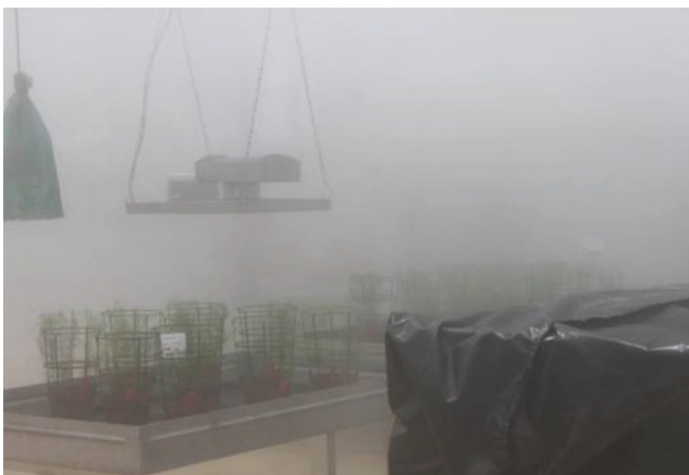
Abb. 4 Nebelkammer kurz nach dem Sprühen der Nebeldüsen
