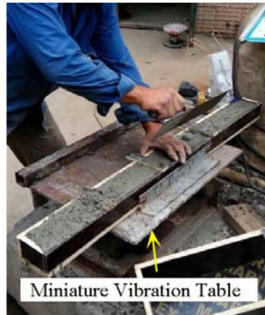
a. Pouring model piles on the miniature vibration table
