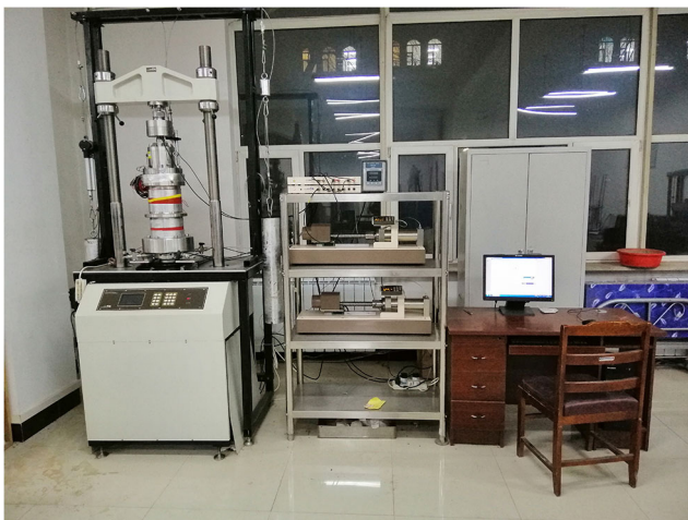
Fig. 1 Triaxial rheometer apparatus (GDS HPTAS)
