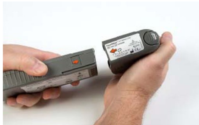
Abb. 7 ▶ Batterie-wechsel HeartMate II. (Mit freundl. Genehmigung von Thoratec Inc., Pleasanton CA, USA)
