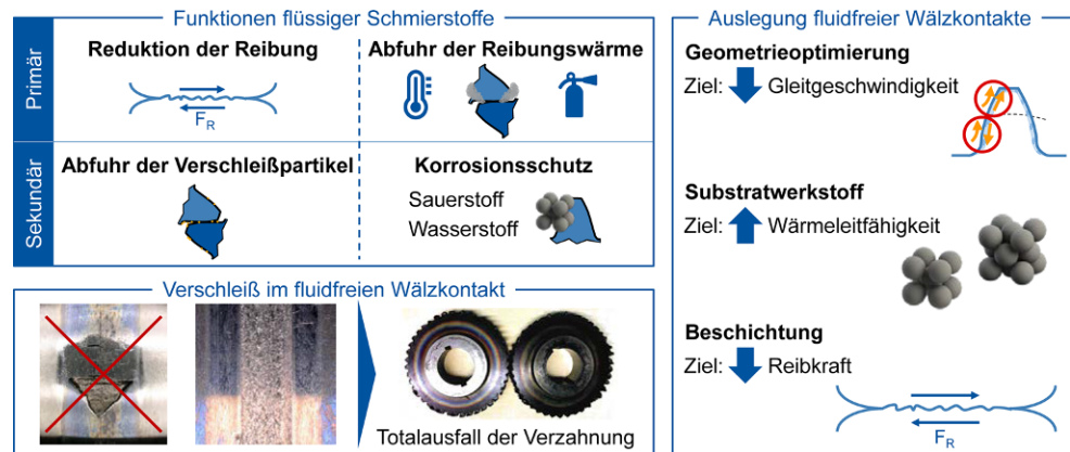
Abb. 1 Verschleiß im fluidfreien Zahnkontakt
