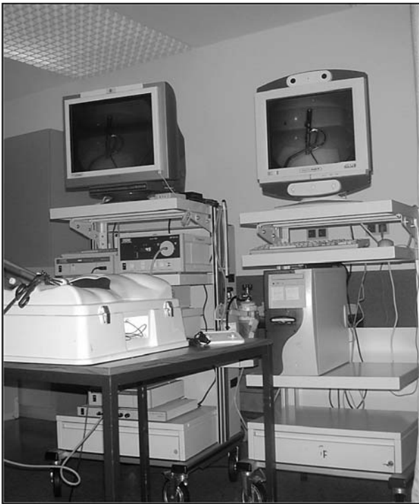
Abb. 1 ◀ Darstellung des Versuchsaufbaus mit den verschiedenen Bildwiedergabesystemen: Storz-3D-Videomonitor (links), Dresdner-3D-Display (rechts), vorn Endoskopie-trainer
