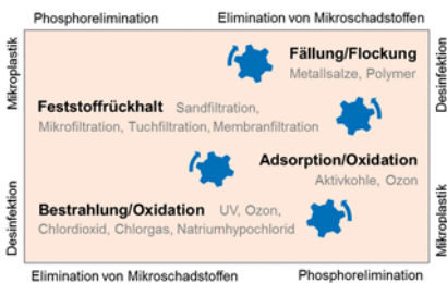
Abb. 4 Technologien für eine zukunfts-fähige Abwasserbehandlung
