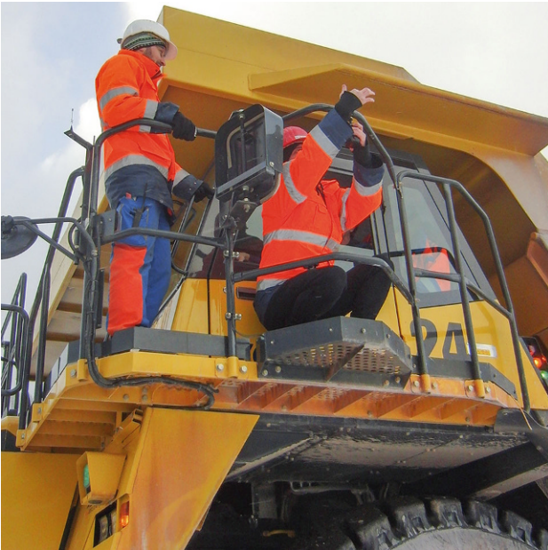
Abb. 3: Montage einer 3D Kamera an einem SLKW, Steirischer Erzberg
