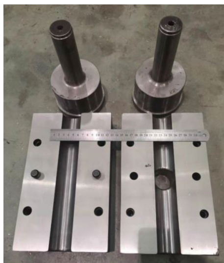
Fig. 21 Die and punches ( \Phi 40 mm)
