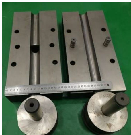
Fig. 17 Die and punches ( \Phi 32 mm)
