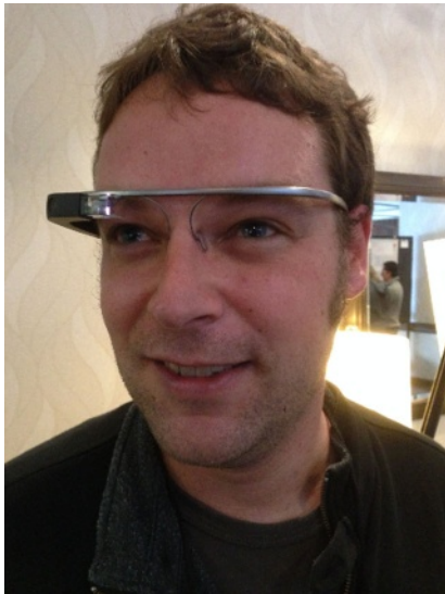
Abb. 4 Google's Glass – ein Repräsentant für die neue Generation leichter und verhältnismäßig unauffälliger Datenbrillen, welche es ermöglichen, virtuelle Inhalte in die Umgebung des Nutzer einzublenden und in naher Zukunft vielleicht genauso alltäglich werden wie heutzutage Mobiltelefone
