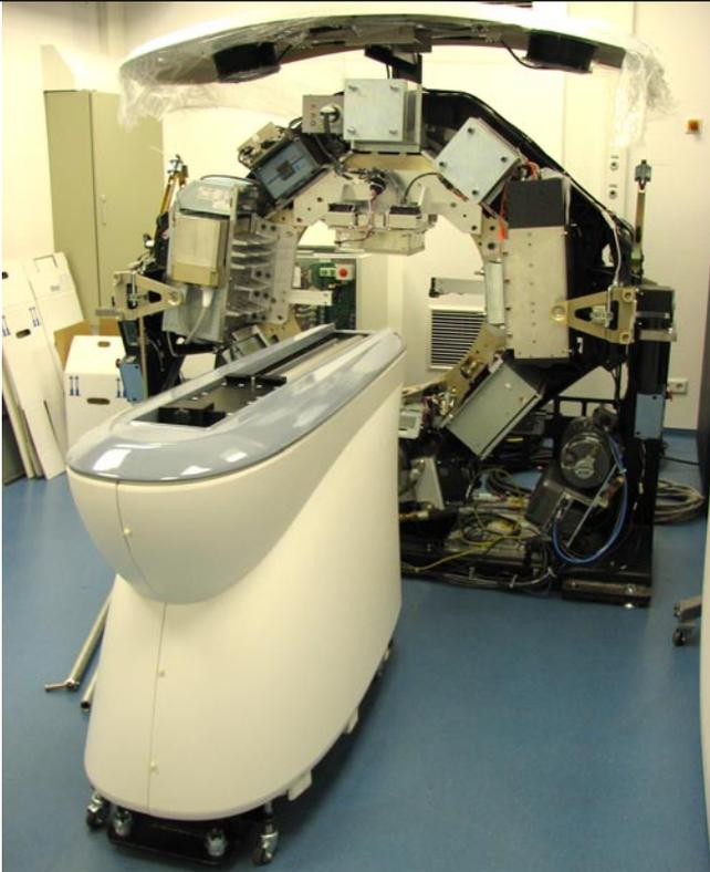
**Abb. 1** ▲ Der eXplore Locus Ultra (eLU) nach Entfernen des Gehäuses. Das einzelne Flat panel ist in der Mitte über dem Scanfokus zu erkennen
