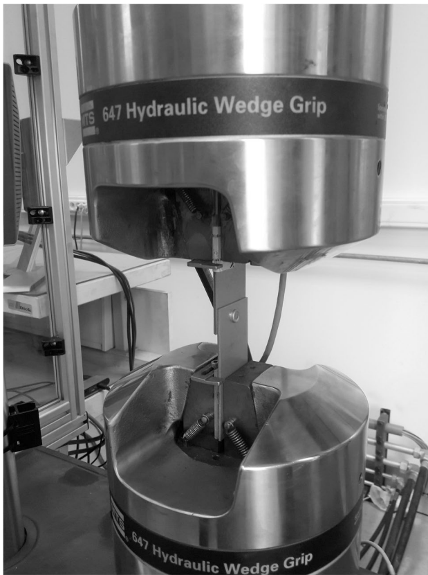
Fig. 4 Tensile test setup
