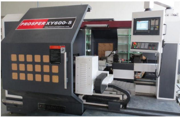
Fig. 9 PS-CNC SX Y 600-5 5-axis CNC spinning machine
