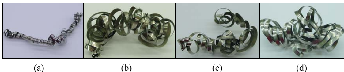
Fig. 7 Chip morphologies under FC (feed rate=0.10 mm/r). a v=60 m/min, b v=75 m/min, c v=105 m/min, d v=120 m/min
