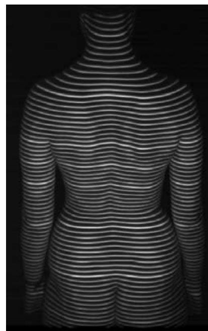
Abb. 1 ▲ Rasterstereographische Rückenvermessung: aufprojiziertes paralleles Linienmuster
