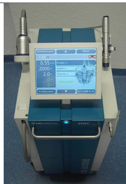
Abb. 8 ▲ Extracorporales Stoßwellengerät (Duolith SD1, Storz Medical, Kreuzlingen, Schweiz) mit beidseits des Touchscreens befindlichen Applikatoren mit unterschiedlichen Durchmessern und Applikationsarten ( rechts fokussierte Stoßwellen, links radiale Druckwellen)
