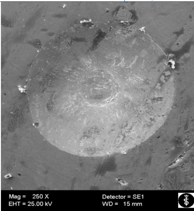
Abb. 3 ◀ Eindruck des Prüfdorns in 250facher Vergrößerung. Es sind am Rand des Kraters keine Abplatzer oder Einrisse zu erkennen; ein Nachweis für ausgezeichnete Schichthaftung. Die vereinzelt sichtbaren weißen Partikel sind lediglich Staubpartikel, die nicht komplett entfernt werden konnten
