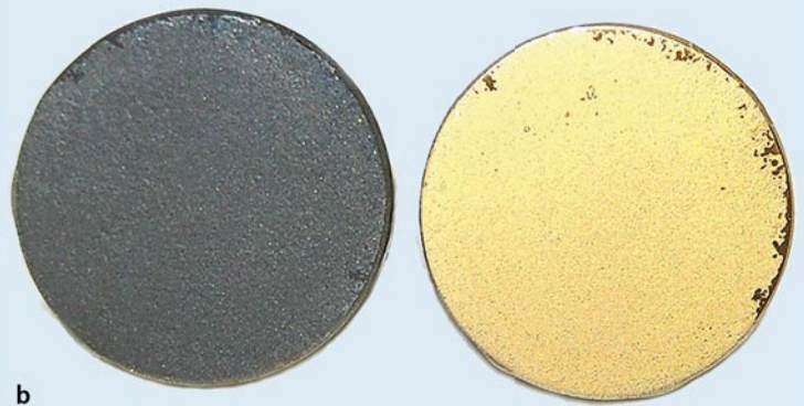
Abb. 5 ▲ a Die TiN-Beschichtung auf poliertem TiAl_6V_4 zeigt bei einer Ritzprüfkraft von 200 N kein Abplatzen. b Kein Abreißen der TiN-Schicht während des Stirnabzugversuchs: links gestrahlte unbeschichtete Fläche mit Kleberesten, rechts TiN-Beschichtung mit Kleberesten
