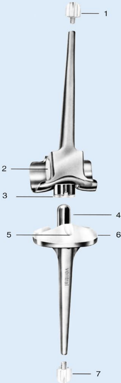
Abb. 3 ▲ Einzelteile des Kreuzgelenks. 1: Mutter, 2: Achsenstift, 3: Kunststofflager, 4: transversaler Zapfen der T-Achse, 5: T-Achse, 6: Rotationsbuchse
