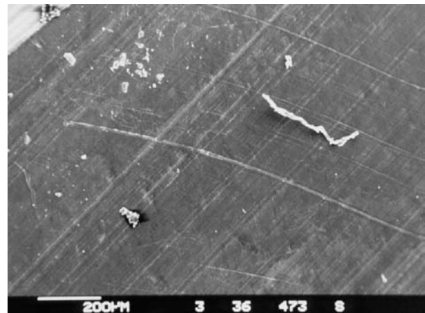
Abb. 12 ► Abgehobene Späne auf der Tribokontaktzone des medialen Plateaus bei 1°-Valgisierung
