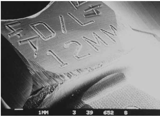
Abb. 6 ◀ Zentraler PE-Bereich mit „Nebentragbild“
