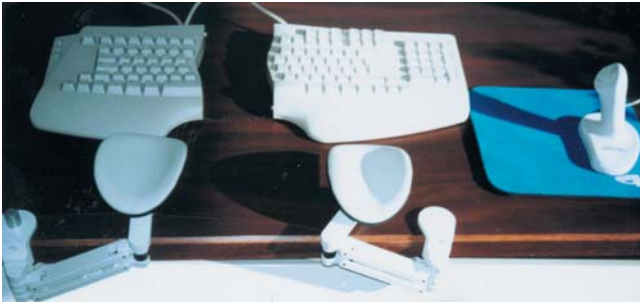
Abb. 2 ▲ RSI und ergonomischer Bildschirmarbeitsplatz. Unterarmstützen entlasten die Nacken- und Schultermuskulatur. Eine geteilte Tastatur und die vertikale PC-Maus gestatten einen biomechanisch günstigen, aber auch schnelleren Bewegungsablauf. Eine RSI-Genese durch hochfrequente Bewegungswiederholung wird durch ergonomische Geräte nicht automatisch verhindert
