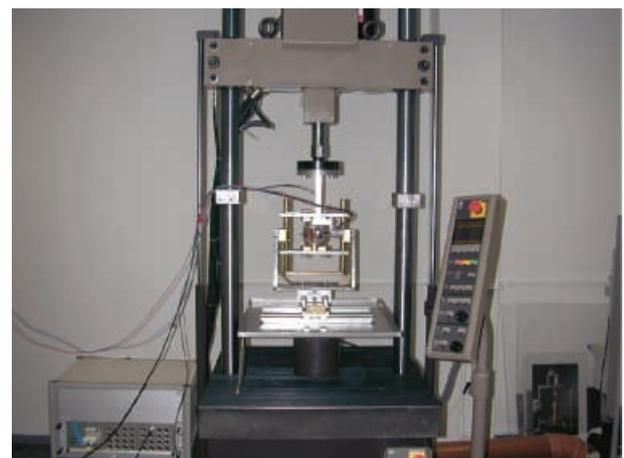
Abb.4 ► MTS 858 mit eingespanntem Präparat
