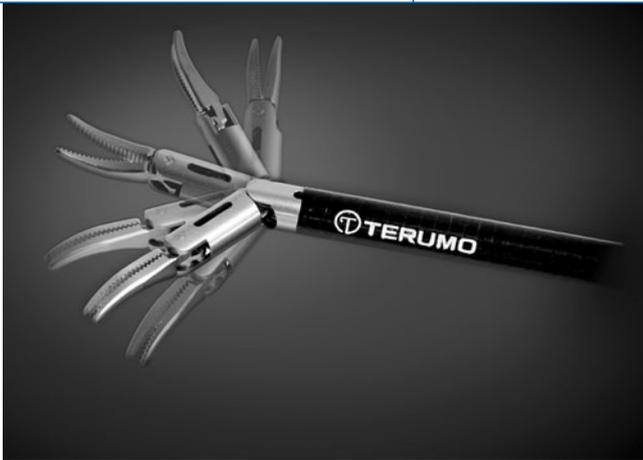
**Abb. 2** ◀ Dimensionen der Instrumentenbeweglichkeit. Neben manuellem Öffnen und Schließen ist das Endstück durch ein inneres elektronisch übertragenes Element in der Lage, um insgesamt 320° zu rotieren und um insgesamt 140° abzuwinkeln. (Mit freundl. Genehmigung der Fa. Terumo)
