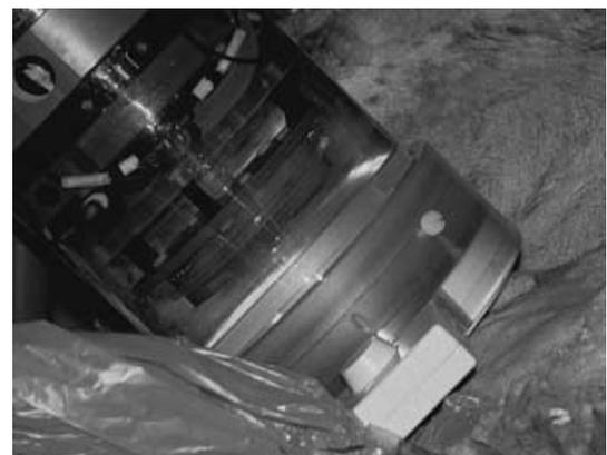
Abb. 2 ► An die Mamma eines Versuchstieres angekoppelter MRT-kompatibler Ultraschallapplikator. Innerhalb des zylinderförmigen Applikators ist die auf einem 3D-Positioniersystem angebrachte Ultraschallquelle sichtbar. Die Verwendung einer MRT-Oberflächenspule sorgt für eine optimale Bildqualität.
