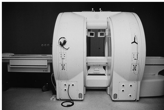
Abb. 2 ◀ Offenes Mittelfeldsystem (0,5 T) (Signa SP, Fa. General Electric)
