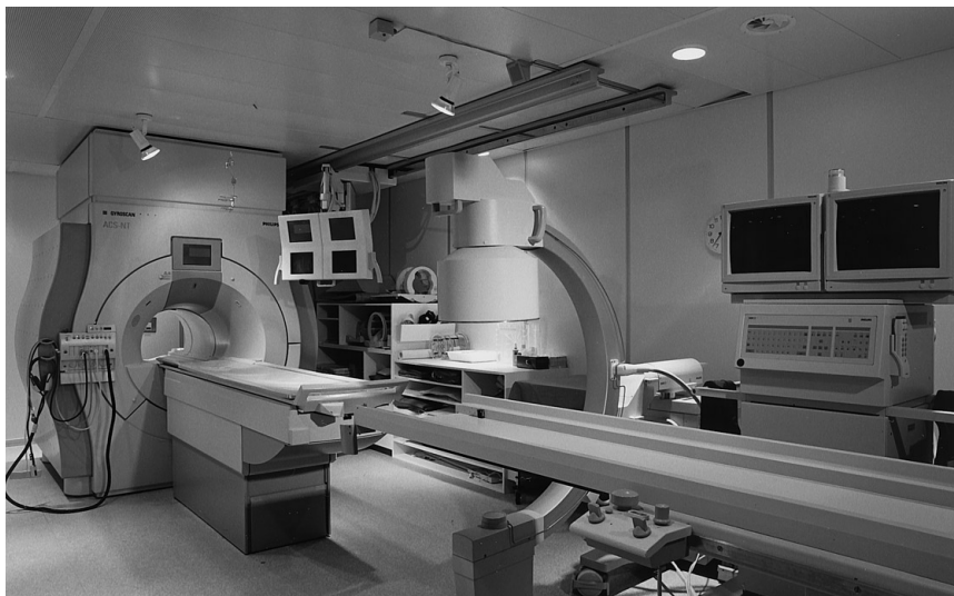
Abb. 3 ▲ Geschlossenes Hochfeldsystem in Kombination mit einem Bildverstärker (ACS NT 1,5 T mit BV 212, Fa. Philips)
