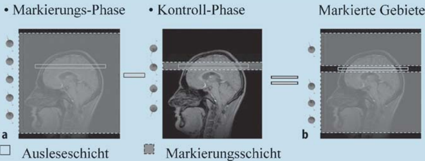
Abb. 2a,b ▲ Prinzip der FAIR-Technik (flow-sensitive alternating inversion recovery). In der Markierungsphase werden sämtliche Spins des Markierungsbereichs invertiert. Anschließend werden nur die Spins der Ausleseschicht (weißes Kästchen) invertiert (a). Die Differenz beider Aufnahmen der Ausleseschicht liefert das Signal des Blutflusses (b). ● Abbildung in Farbe siehe Seite 197
