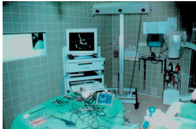
Abb. 1 ▲ Intraoperativer Aufbau eines Navigationssystems (hier: Surgigate, Medivision) während einer dorsalen Instrumentation an der Halswirbelsäule. Im Vordergrund die Kabel, mit denen jedes Instrument an das System angeschlossen werden muss
