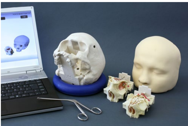
Abb. 5 ▲ NNH-Phantom zur Messung der Genauigkeit und chirurgischen Situationsaufmerksamkeit
