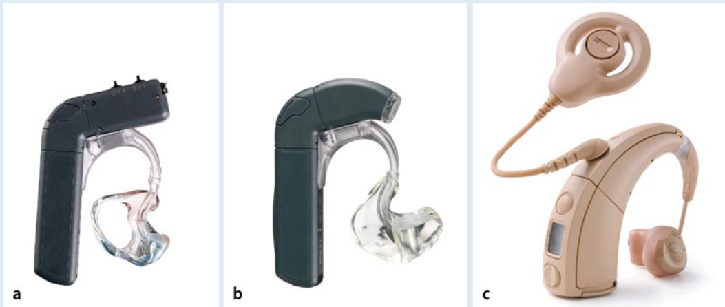
Abb. 2 ▲ EAS-Prozessoren. a DUET-Sprachprozessor, akustischer Wandler integriert im Ohrhaken, Ankopplung über konventionelle Maßtopplastik, b DUET-2-Prozessor, Einstellung über Fernbedienung, Markteinführung Februar 2009 (Fa. MED-EL, Innsbruck), c Freedom für Hybrid, maßangefertigte Ohrschale enthält akustischen Wandler, Ankopplung über speziellen Ohrhaken, Markteinführung geplant (Fa. Cochlear, Hannover)
