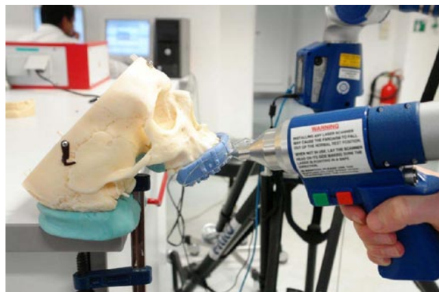
Abb. 1 ◀ FARO-Messarm zur Bestimmung der Position der Referenzpunkte auf den Bissschienen
