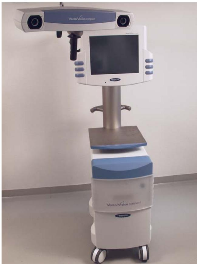
Abb. 1 ◀ Die Hardware des VectorVision Compact®: eine fahrbare Workstation mit Flachbildschirm und flexiblem Kameraarm
