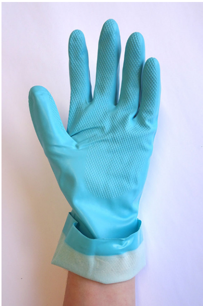
Abb. 5 ▲ Flüssigkeitsdichter Nitril-Handschuh mit umgeschlagener Stulpe („Regenrinne“) für „Überkopfarbeiten“, damit keine Flüssigkeit in den Handschuh einläuft
