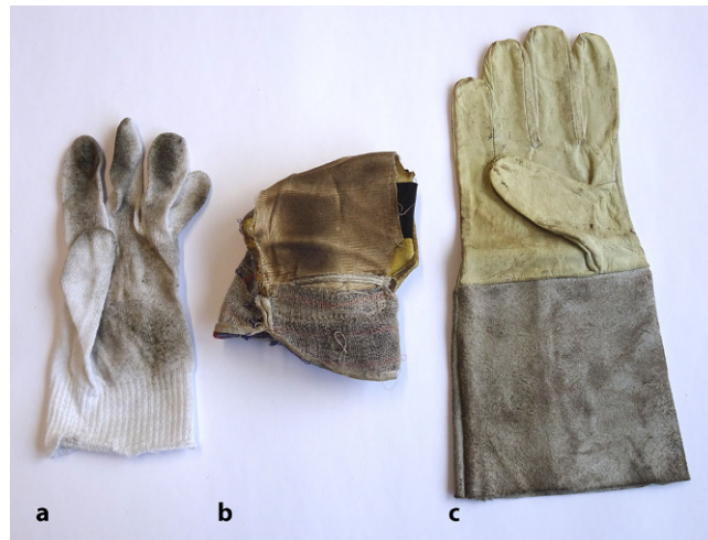
Abb. 6 ◀ Stark verschmutzte Handschuhe aus der Praxis. a Ehemals völlig weißer Baumwollunterziehhandschuh. b Stark verunreinigte Innenseite eines Leder-Textil-Handschuhs mit rauen Nähten. c Neuer, ungetragener Schweißershandschuh, der durch falsche Lagerung verschmutzt ist
