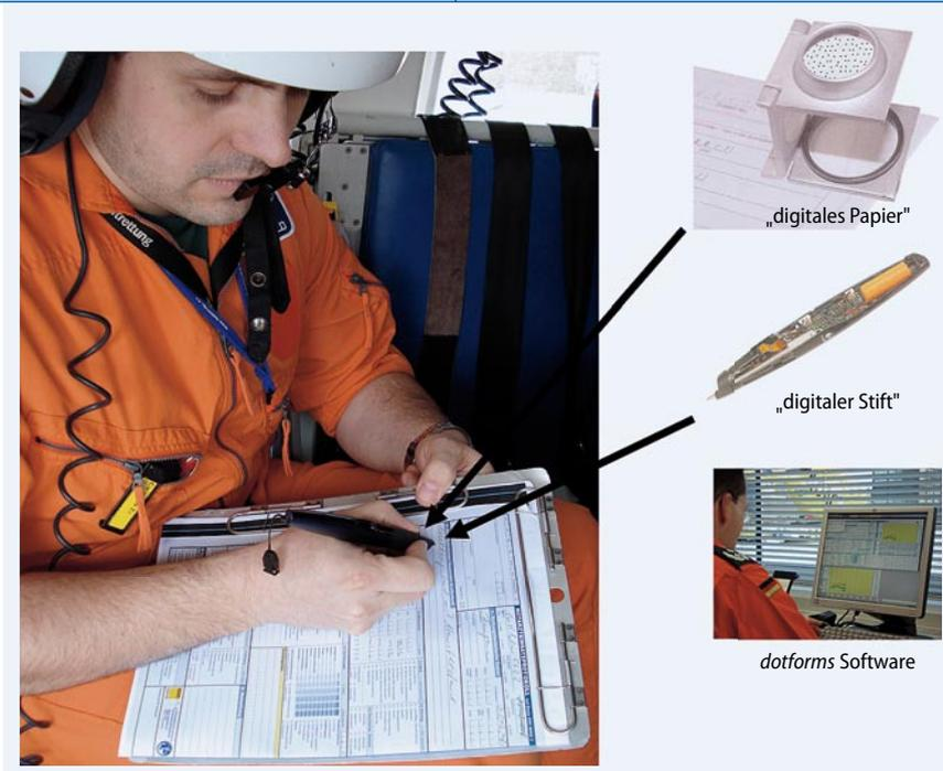
**Abb. 1** ▲ Die 3 wesentlichen Komponenten der neuen Dokumentationstechnologie: das „digitale Papier“, der „digitale Stift“ und die dotforms®-Anwendungssoftware
