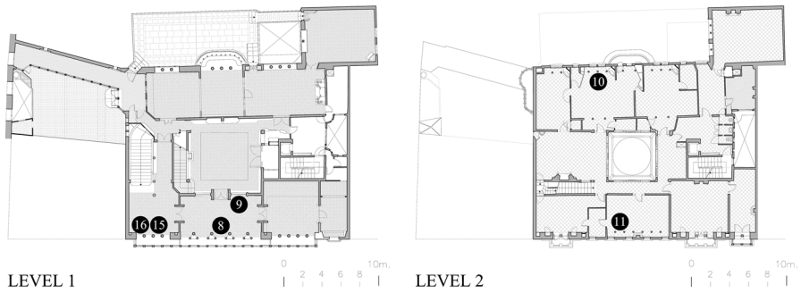
Fig. 3 Location of the arches on level 1 and level 2 of the building. This graphic document is reproduced with the permission of the Arxiu del Servei de Patrimoni Arquitectònic Local de la Diputació de Barcelona
