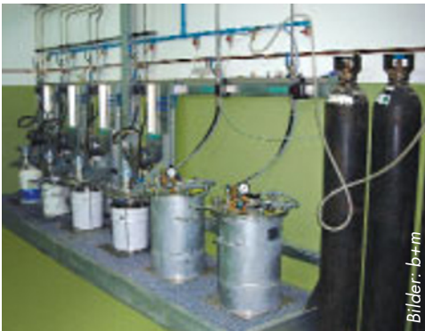
Die Lackversorgung ist auf zwei Wasser- und zwei Lösemittellacke ausgelegt. Von hier aus werden auch Spülmittel, VE-Wasser und Lösemittel über Stichelungen verteilt.
