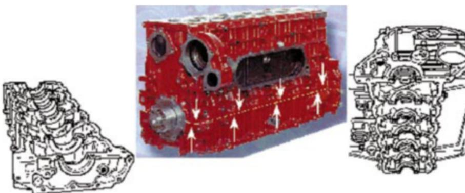
Bild 2: Motorblock des Cursor 8
