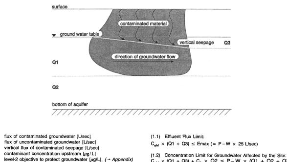
$C_{eM} \times (Q1 + Q3) + C_n \times Q2 \le P - W \times (Q1 + Q2 + Q3)$
